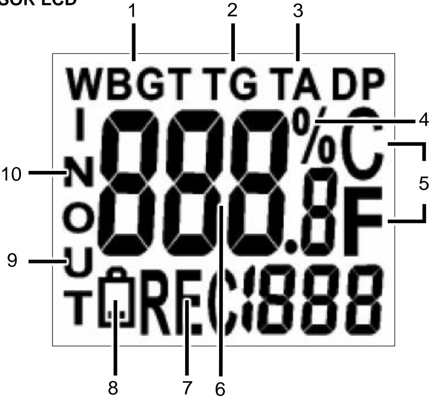
1 - Indicação da medição de stress térmico (IBUTG): WBGT
